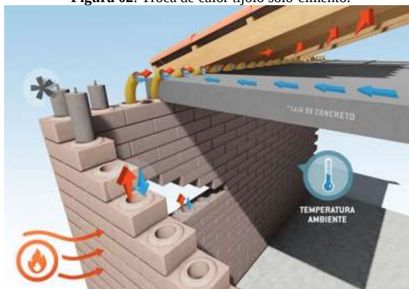
Figura 02: Troca de calor tijolo solo-cimento.
