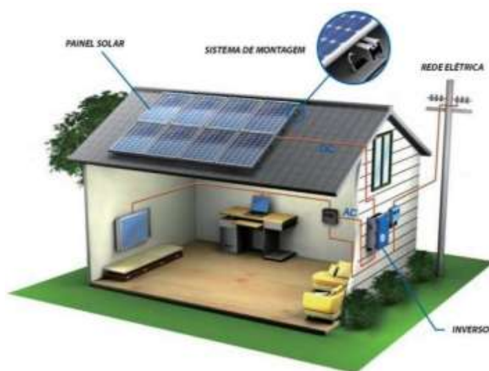
Figura 03: Sistema de funcionamento energia fotovoltaica
