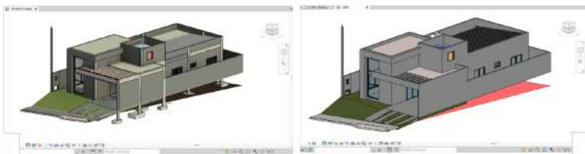
Figura 2: Compatibilização dos projetos arquitetônicos e estrutural
